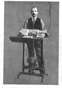
Der neue Briefpoststempel und seine Druckmaschine.
