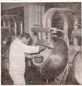
Auch gewisse Dragées — eine der beliebtesten Arzneiformen — können nur unter Zuhilfenahme von Alkohol hergestellt werden. Man braucht ihn für die den Kern umhüllenden Isolierschichten, doch wird er durch ein spezielles Ver-fahren dem Produkt wieder entzogen.
