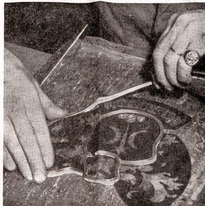
Jedes einzelne Stück wird mit «Bleisprossen» (das sind dünne bleierne Profilstäbe) eingefügt. Diese Arbeit erfordert ein sehr exaktes Schaffen, denn hierbei kommt es oft auf einen Zehntelmillimeter an.
