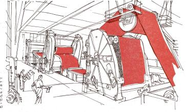
Im hohen hellen Fa-brikraum der Lino-leum Giubiasco: In der großen Kalander-maschine wird die Linoleummasse (auf unserem Bild farbig) in das Juteband ein-gepreßt. (Kölla)
