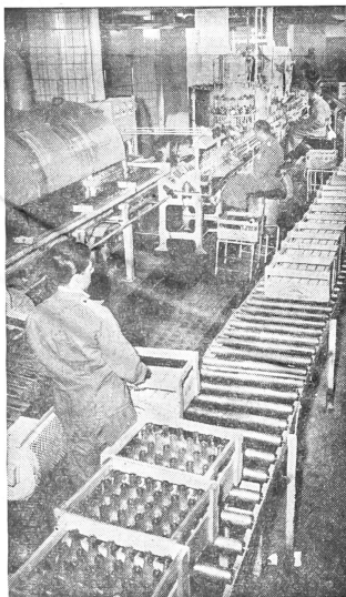
Teilansicht des Maschinsaals von der Waschmaschine bis zur Korkmaschine.
