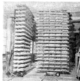
Frisch geformte Dachziegel, auf Holzrähmchen gelagert, werden in die Trockenkammer gefahren.
