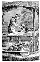
Durch ein Strohdächlein vor der geschützt, formte der Handziegler Freien seine Mauersteine, die er dann zum Trocknen aufschichtete.
