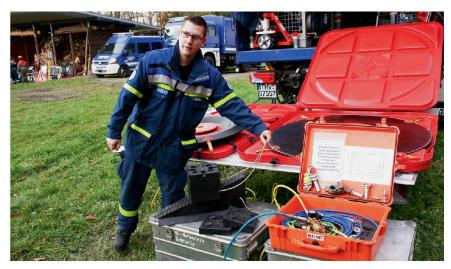
Demonstration von grossen Hebekissen des Technischen Hilfswerks.
