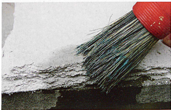
Bei der Probeentnahme soll bei weichem oder sprödem Material die Staubbildung durch Befeuchten mit Wasser verhindert werden.
