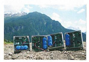
Die RockNet-Sensoren – hier vor der Montage – messen Erschütterungen im Gelände.
