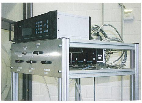
Als Kernelement zur Überprüfung des Funktionsmodells «DACHS» steht dem BBK eine moderne Mehrkomponenten-Gasmischapparatur zur Verfügung.
