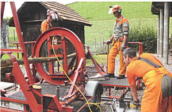
Mit dem Simulator kann man gefahrlos Holz zersägen, das unter Spannung steht.
