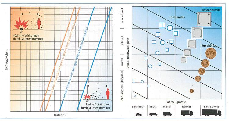
Abbildung 1 zeigt die Splitter- und Trümmerwirkungen auf den Menschen, abhängig vom TNT-Äquivalent der Fahrzeugbombe, und die daraus berechnete Evakuierungsdistanz (die Grafik aus dem Handbuch wird hier ohne die konkreten Daten publiziert).
