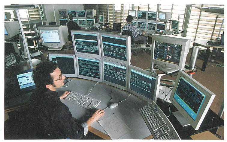
Blick in die Leitzentrale in Basel: Die automatisierte Steuerung erlaubt dichtere Fahrpläne und einen sicheren Betrieb.
