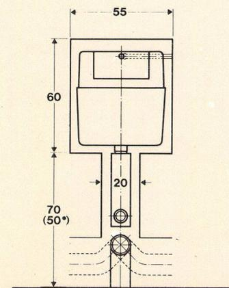
Um den Schalldurchgang von einem Raum in den andern zu dämmen, soll zwischen den Spülkasten eine geeignete Dämmplatte (z.B. 1-mm-Verbundblech) eingebaut werden. Auch empfiehlt es sich in diesem Fall, Chromstahl-Revisionsplatten zu verwenden.
