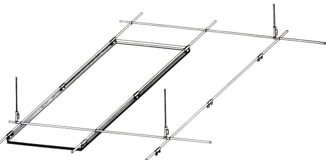
9 Trennwandsystem DBPa und DBGM. Hersteller: Rheinhold und Mahla, Mannheim. Schnitt durch Türelement - Normalwandelement - Fensterelement.
