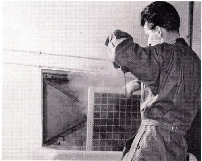
In Spezialmaschinen werden die schmutzigen Filter gewaschen und getrocknet.
