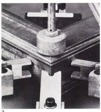
nende Eckwinkel aus Stahl. Dadurch ergibt sich eine Konstruktion von höchster Stabilität und Dauerhaftigkeit. Die Verbindung von Stahl auf Stahl verunmöglicht eine elektrochemische Korrosion, wie sie bei Verwendung von zwei verschiedenen Metallen auftritt. Der Zusammenbau erfolgt mit Hilfe der bewährten Eckverbindungs-maschinen. Diese arbeiten im Preßverfahren und gewährleisten geschlossene Gehrungen und eine Stabilität, die derjenigen der Schweißung entspricht.
