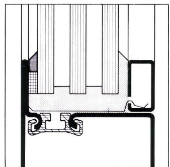
**Die Bautiefe von 60 mm ermöglicht Doppel- oder 3-fach-Verglasung**
