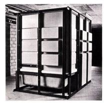
Eine praktische Bauweise und Zugänglichkeit der Installationsteile sind der Vorteil dieses Systems, das sich vor allem für Neuund Umbauten eignet. Die im Rohbau vorgesehenen Sanitärräume werden durch vorgefertigte Elemente ausgekleidet. Fertigelemente aus Acrylglas und Verbindungsteile aus Stahl und Aluminium, mit denen Masstoleranzen aufgenommen werden, ermöglichen eine individuelle Ausstattung und eine differenzierte Farbgebung des Raumes.
