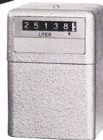
Öl-Zähler HZ 4 Einbau in alle Brennerfabrikate zwischen Ölpumpe und Düse, Messbereich 1 bis 50 l/h, Genauigkeit 1%
