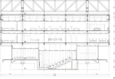
Der dem Gesamtentwurf zugrunde liegende Gedanke, die Decken über ein außenliegendes Tragwerk aufzuhängen, resultiert aus der Entwurfsbedingung, das Erdgeschoß für die Hörsäle und Seminarräume weitgehend stützenfrei zu halten und im 1. und 2. Obergeschoß ein Stützenraster von 7,20 × 7,20 m mit möglichst schlanken Stützen auszubilden.
