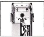
Der seitliche Zwangsantrieb durch Stahlscherenglieder garantiert:
