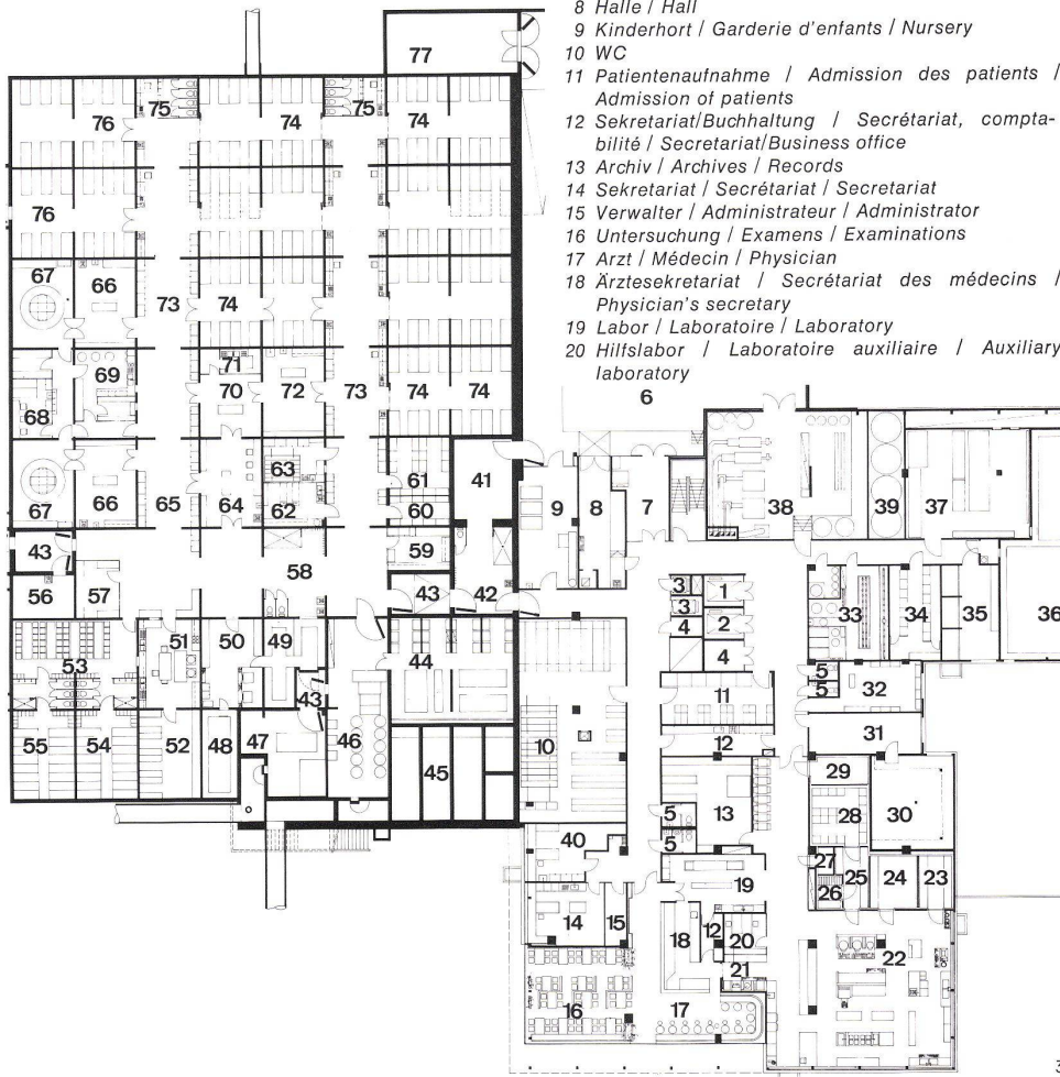
3 Grundriß Untergeschoß mit geschützter Operationsstelle 1:600. Plan du sous-sol avec poste d'opération protégé. Plan of basement with protected operating station.
