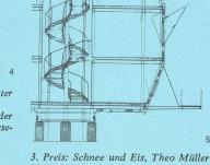
Skelettkonstruktion mit eingesetzten kubischen Raumzellen. Architektonisch ansprechende Eingliederung und Ausnützung der Topographie. Funktionell richtige, aber extensive Interpretation des Raumprogrammes. Das System eignet sich jedoch ohne Verlust an technischer oder architektonischer Qualität auch bei einer Veränderung des Raumprogrammes. Konstruktiv richtige Durchgestaltung des Tragsystems.
