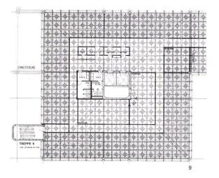
AUSSENSTUT78 2 2 2 2 LANGLOCH ZUR BEFESTIGUNG LEICHTER TRENNMANGE PASSENC 10 Deckenuntersicht 1:500. Die dunkle Fläche: Schwer-auflage (1 mm Blech und darüberliegende Schallschluckmatte) als horizontale Schallabschottung.
