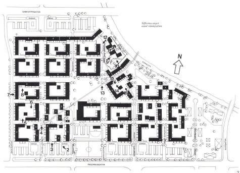
Die Anlage liegt in einem bestehenden Gebiet in einer zentralen schwedischen Industriestadt mit einer 25 000köpfigen Bevölkerung. Die Anlage umfaßt 165 000 m², der Untergrund besteht aus einer Sand-Lehm-Mischung, und die Oberfläche steigt leicht gegen Westen an.
