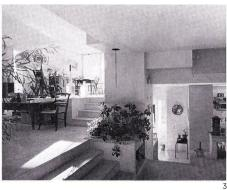
Das Haus in Rustrel, in der Nähe von Apt in der Vancluse, basiert auf den Grundsätzen der »passiven« Sonnenenergie-Gewinnung. Der Temperaturausgleich und die Kontrolle der Einstrahlung wird erreicht durch die Anordnung des gebauten Raumes und seiner Umschließungsflächen und den Zusammenhang von Oberfläche und Masse.
