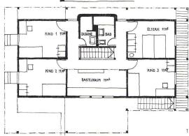
Das Projekt zu diesem Wohnhaus entstand im Herbst 1975. Seine Konzeption ergab sich aus den Wünschen des Bauherrn, der Topographie und Erschließung des Grundstückes sowie der Konstruktion. Es handelt sich um eine Holzkonstruktion, die mit Leichtbauplatten ausgefacht ist. Der Entschluß, Sonnenenergie zur Beheizung heranzuziehen, beeinflußte die Projektierungsarbeiten nicht grundsätzlich.
