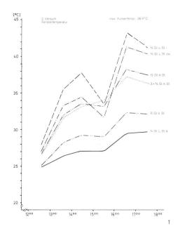
Der Verlauf der Fenstertemperatur bei verschiedenen Sonnenschutzdispositionen.
