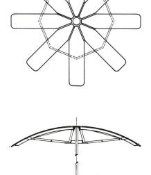
La plus grande hauteur de mât est de 11,30 m, les parois latérales formées d'un simple rideau oscillent entre 1,50 m et 7,40 m.
