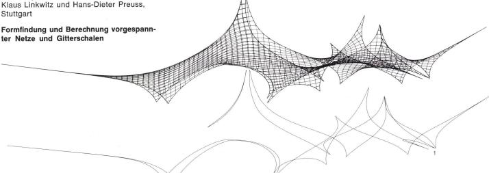
Die normalen zeichnerischen Hilfsmittel des Architekten beim Entwerfen sind Zeichnung und Skizze. Diese Mittel reichen nicht aus, wenn es um die Entwicklung und Darstellung doppelt gekrümmter Seilnetze geht. Computerzeichnungen sind eine wertvolle Entwurfshilfe beim Formfindungsprozeß.
