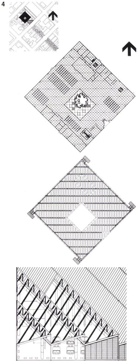
Umhüllungselemente: integriert mit der Struktur und vorgefertigt: Dach aus isolierten Metalpanelen, Außenwand aus Fiberglas, Innenwand aus klarem Glas. Außen: Die Gebäudeform entsteht als Ausdruck der Systeme. Farben: Außen Silber, innen Weiß, Blau und Gelb.
