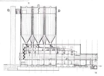
kung erfolgt über den Lift- und Treppenhausturm und über eine Stahlpasserelle in die acht Silos der Verladeanlage. Sechs gleich große Silos mit 11 m  $\phi$  sind achsialsymmetrisch so angeordnet, daß in der Mitte zwei Zwecksilos für Sonderzemente Platz haben. Die Lastabtragung erfolgt über 17 Scheibenstützen, die punktsymmetrisch so angeordnet sind, daß die notwendigen Durchfahrtsbreiten für die Abholfahrzeuge entstehen.
