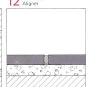
6 Zwischenfugen mit Kitt Joints avec mastic
