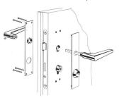
Für die Montage des Sicherheitsschildes braucht der Schloßkasten nicht durchbohrt
