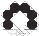
Weil die erforderliche Fläche im Erdgeschoß kleiner ist als jene der oberen Stockwerke, wird die quadratische Einheit durch eine achteckige ersetzt.
