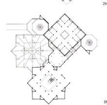
Das Gebäude bildet den ersten Abschnitt einer größeren Bauanlage. Zum ersten Mal wurde ein geometrisches Feld verwendet, das sich aus »rotierenden« Quadraten zusammensetzt. Die Studios sind in den auf den Quadraten aufgebauten Räumen untergebracht.
