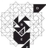
Besondere Merkmale des Gebäudes sind Balkone als Aufenthaltsraum A, das Oberlicht über dem Hof B, das Schwimmbad C, der Eingang D, der äußere Hof E und der Garten F. Alle Grundrißfor-men basieren auf Elementen des geometrischen Feldes oder seiner Erweiterungen.
