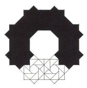
Die Abmessungen des Rings sind abhängig von der Anzahl und den Flächen der Räume, die auf jedem Stockwerk benötiat werden.
