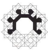
Die zentralen Verkehrswege auf den oberen Stockwerken bestehen aus einem ringförmigen Korridor. Der Zu-gang zu den Büroeinheiten führt durch Empfangsraum. Diese Anordnung teilt jedes Stockwerk in Untereinheiten, was dem »Bewohner« die bessere Identifikation mit seinem Arbeitsplatz auf »seinem« Geschoß ermöglichen soll.
