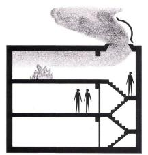
Sicherer Ab- und Zugang dank entlüfteten Treppenräumen.
