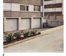
9 Anliker + Co AG, Emmenbrücke Kipptore, halbverschwindend, mit Seilzug. Hubtore mit Gegengewichten und Seilzug Portes basculantes à câbles, partiellement escamotables. Portes coulissantes verticales à câbles et contre-poids
