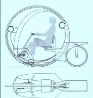
Punkten geführte Vorderrad übertragen. Der Fahrer wird geschützt durch einen bis hinter den Kopf verlängerten Windschutz, der jedoch, wie der Prototyp zeigte, bei nasser Fahrbahn durch das Vorderrad beschmutzt wird. Gesteuert wird mit den Hinterrad, was anscheinend gar nicht so einfach ist.
