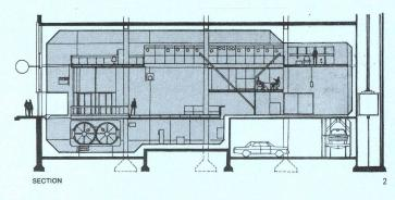
Hauptbüro. Industriebaumaterialien, Glasbausteine und Stahlkonstruktionen bilden eine geschlossene Hülle. Glaskäfige verbinden innen und außen.
