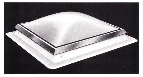
Tragendes Element jeder CUPOLUX-Lichtkuppel ist ein massiver Aufsetzkranz aus Polyurethan-Duromerschaum. Dieses homogene, mit einer doppelten DD-Lackierung überzogene Material von bester statischer Festigkeit ist extrem wasser- und witterungsfest. Der 15 cm breite Klebeflansch des Aufsetzkranzes gewährleistet die problemlose Verbindung mit allen handelsüblichen Flachdachabdichtungen.
