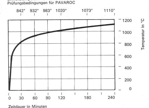
Dass PAVAROC-Mineralfaserplatten die brandschutztechnischen Anforderungen erfüllen, beweisen die Technischen Auskünfte der Vereinigung kantonaler Feuerversicherungsanstalten.
