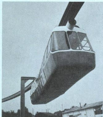
1 Versuchsanlage in Schmerikon am oberen Zürichsee. Geraadlinige Streckenführung mit vorgespanntem Seiltragwerk, Stütze auf einem schwimmenden Ponton.
