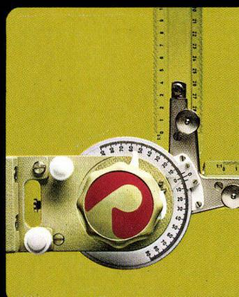
**Zeichenkopf 5783.32.** Präzisions-Vollkreis-Zeichenkopf, 360°-Drehbereich, Nonius mit Zehntelsgradteilung, 15°-Rasterung, Klemmwippe für Zwischengradfeststellung, mit Basisverstellung und Doppelgelenkbrücke.
