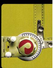
Zeichenkopf 5783.32. Präzisions-Vollkreis-Zeichenkopf, 360°-Drehbereich, Nonius mit Zehntelsgradteilung, 15°-Rasterung, Klemmwippe für Zwischengradfeststellung, mit Basisverstellung und Doppelgelenkbrücke.
