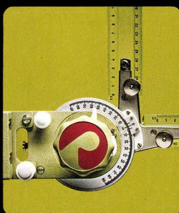
**Zeichenkopf 5783.32.** Präzisions-Vollkreis-Zeichenkopf, 360°-Drehbereich, Nonius mit Zehntelsgradteilung, 15°-Rasterung, Klemmwippe für Zwischengradfeststellung, mit Basisverstellung und Doppelgelenkbrücke.
