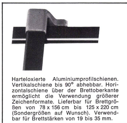
Die neue, durchdachte Brettmontage ermöglicht die Veränderung der Symmetrie des Zeichenbrettes zum Ständer nach beiden Seiten um je 34 cm.
