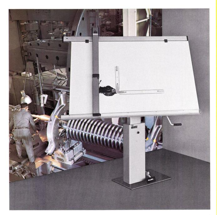
Die Höhenverstellung des Reissbrettes dieses Einsäulenzeichenständers erfolgt mittels einer ausgleichenden Gasfeder, welche durch ihre ingeniöse Konstruktion ein Gegengewicht oder eine bemühende Pump-Hydraulik vermeidet. Das Reissbrett ist 360° drehbar und kann in der Mitte oder auch asymmetrisch angebracht werden. Dadurch wird dieses Zeichengerät innerhalb eines L- oder U-förmigen Arbeitsplatzes beliebig und am besten Platze angebracht.
