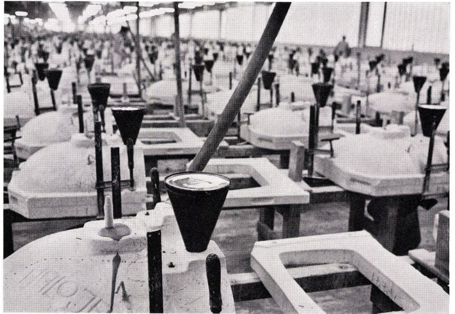
Die Gießmasse (Schlicker) wird via Pipeline in die Gipsform gepumpt.
