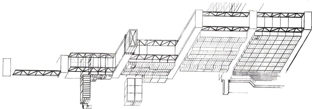
Raumzellenbauweise, bei der die raumbildenden Ausbauelemente in ein orthogonales Stahltragwerk eingepaßt werden.
