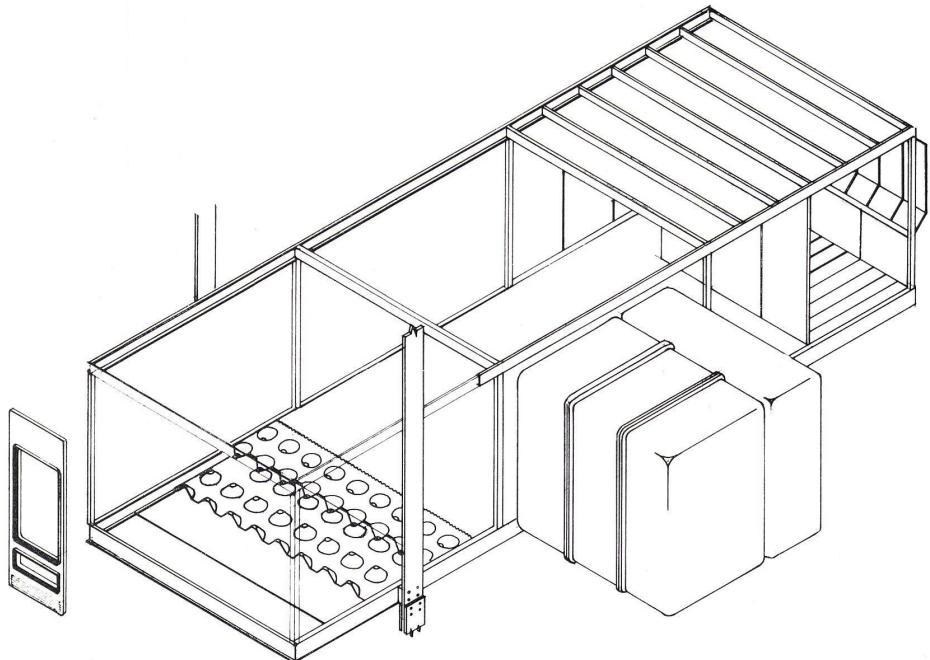
Stahl-Hängehaus-Bausystem, das von »unten nach oben« wachsen kann, d. h., das Gittertragwerk zwischen den kastenförmigen Stützen, in denen die Treppenanlagen und die Installationszu- und -ableitungen untergebracht sind, wird mit den daran hängenden Raumzellen hochgezogen und die neu hinzukommenden Zellen unten angehängt.
