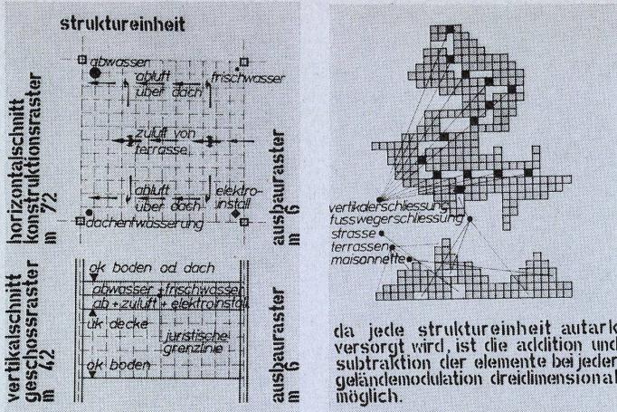
da jede Struktureinheit autark versorgt wird, ist die Addition und Subtraktion der Elemente bei jeder Geländemodulation dreidimensional möglich.
